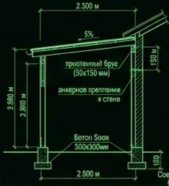
ЧЕРТЁЖ ПРИСТРОЕННОГО НАВЕСА К ЛЕТНЕМУ ДОМИКУ (РАЗМЕРЫ 2.5x5 м, ВЫСОТА 2.8 м) ФАСАД (ПЕРЕДНИЙ ВИД)
